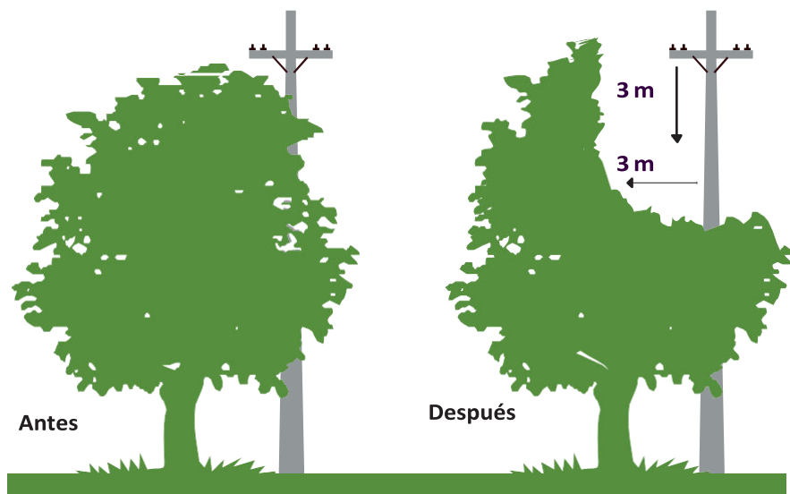
Figura 4: Poda lateral alrededor de las líneas de distribución de energía
